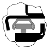
Afb. 63: C-rail en geleidingsrollen
