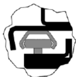
Immagine 62: Profili a C degli scorrimenti e cuscinetti guida
