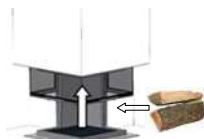
Illustration 31: Remonter la porte et ajouter du bois
